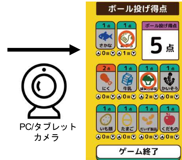
図11 高齢者施設でのボール投げゲーム自動判別アプリ (カメラで的の映像をカメラ撮影して得点を自動判別するPC/タブレット用ゲーム)
